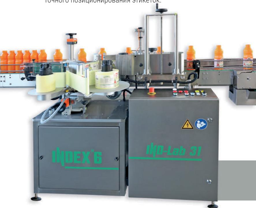
Машины для наклеивания одной этикетки на цилиндрическую упаковку.
